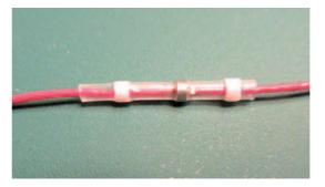
Die Kabel in die Löthülse schieben, so dass die Verbindungsstelle unter dem silbernen Lötzinnring liegt.
